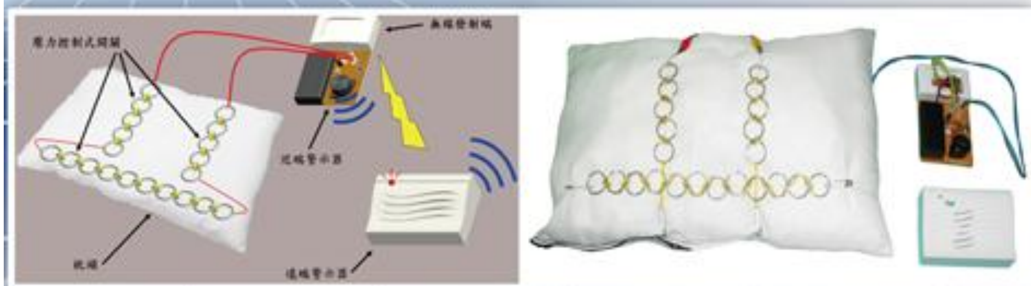
圖三 壓力控制式軟墊 應用於嬰兒枕頭之圖示說明
